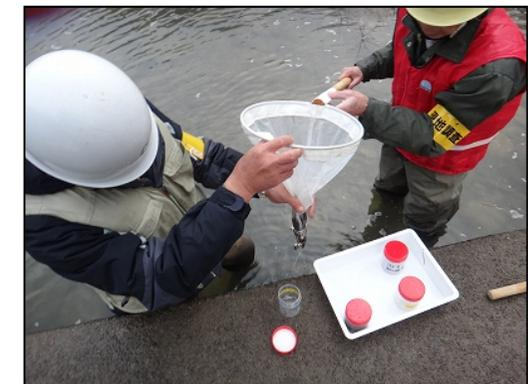
※ 流下物の採取は、開口面積約700cm<sup>2</sup>、目合い63μmの網を30秒間(放流後日は180秒間)流水中に設置することで行った。また、設置中に流速を測定して通過水量を算出し、流下物の濃度を計算した。
