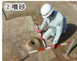
河川水が透水性の高い層に浸透し、最も抵抗の小さい箇所から浸透水とともに細粒土砂が地表に噴き出し、噴砂が発生。
