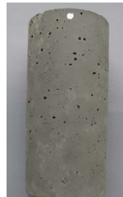
写真－2 カルシア改質土供試体 (カルシア改質材容積混合率40%) 2)
