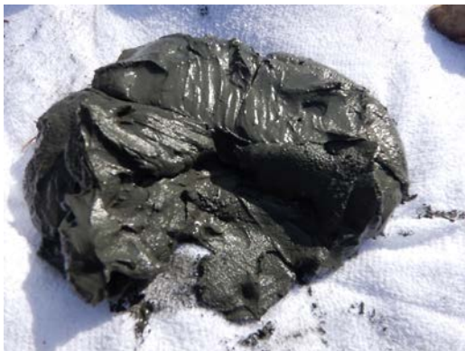
写真－1 採取した浚渫土 2)
