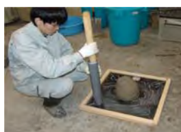
写真-1 タンピング試験と加振ボックス充填試験の実施状況
