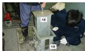
写真-1 タンピング試験と加振ボックス充填試験の実施状況
