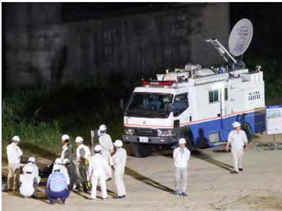
写真－8 Ku-SAT II 設営状況
