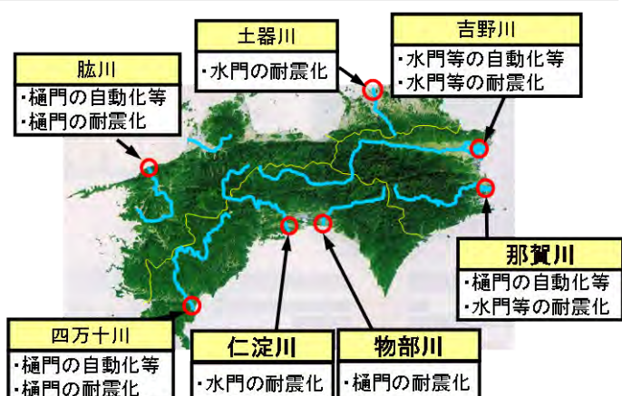
図 水門・樋門の耐震化および自動化等 実施状況
