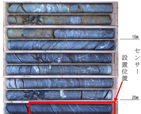
図 4-1 ボーリングコアの例（名頃地区）
