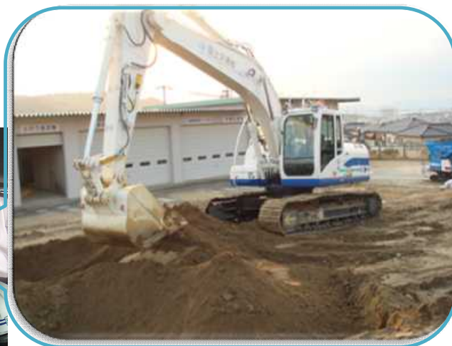
1.0m 3 級遠隔操縦式バックホウにより、約 100m 離れた場所からカメラ映像を見ながらの遠隔操作訓練状況
