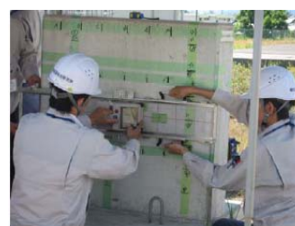
鉄筋破断測定中
