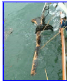
流木を回収するには身を乗り出して、流木をクレーンのアームまで引き寄せる必要がある。
