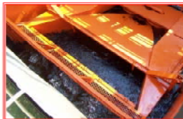
高粘度油の回収状況(悪臭を放つ)。
