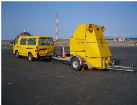
写真-2 FWD試験機
