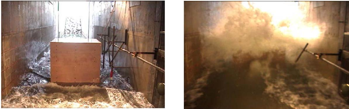
図-6 実験の様子（左：津波が作用する前、右：津波作用後）
