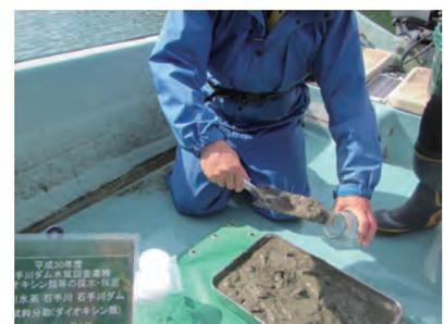
ダイオキシン類の底質分析のための採泥状況
