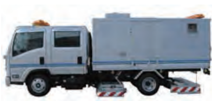
車道部調査で使用する探査車
