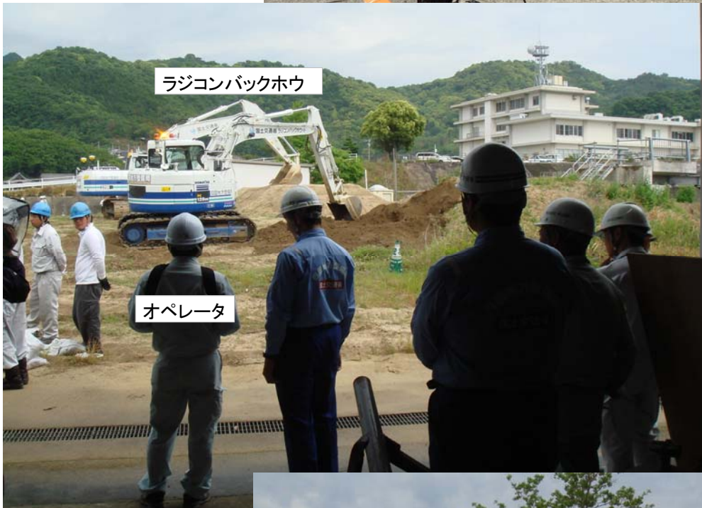
バックホウの 遠隔操縦訓練
