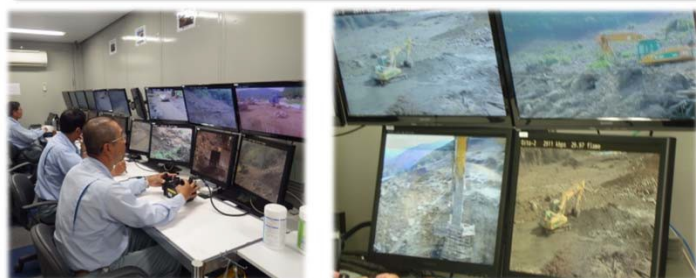
▲遠隔操作で14台の無人化機械が稼働
