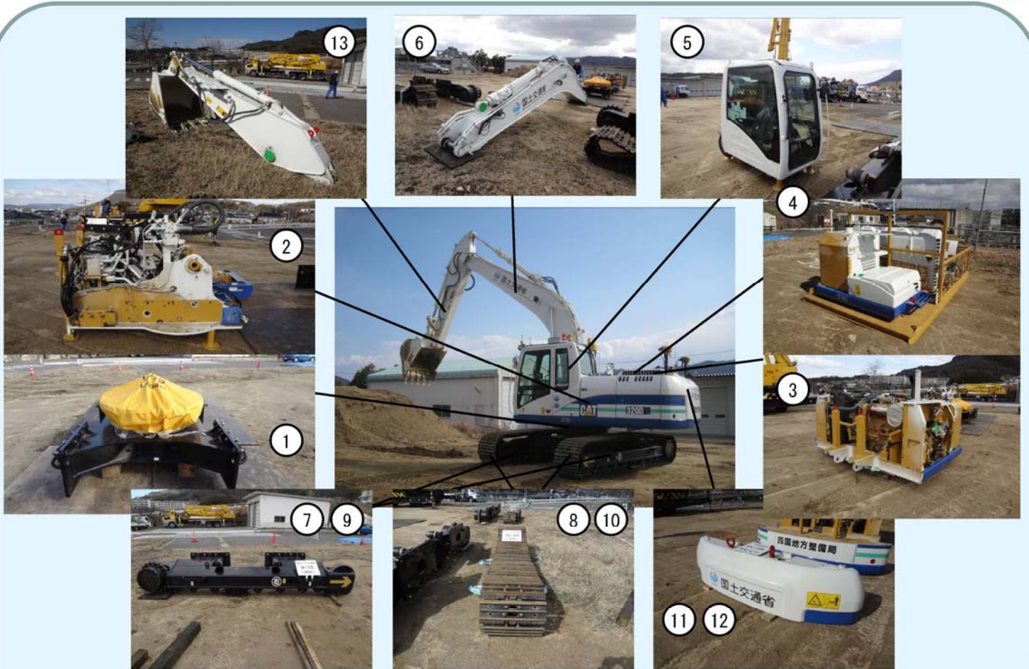
バックホウを13個に分解した時の各パーツ写真
