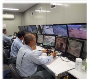
▲遠隔操作で14台の無人化機械が稼働
