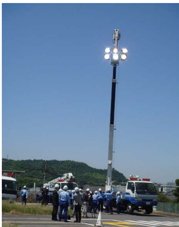
照明車の設営訓練
