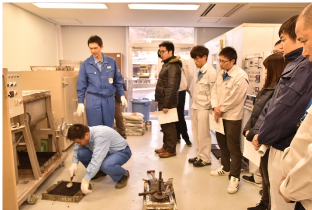
ホイールトラッキング試験の供試体作成
