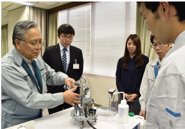
雨量計（転倒マス）の仕組みを確認
