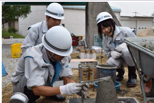
生コンクリートの受入時検査(スランプ)
