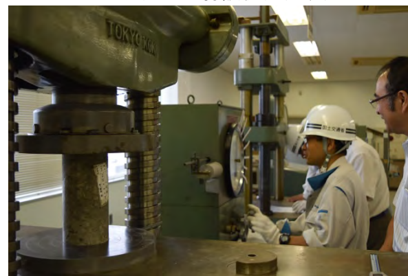
脱型時の強度確認(9月22日) 12N/mm 2 確認
