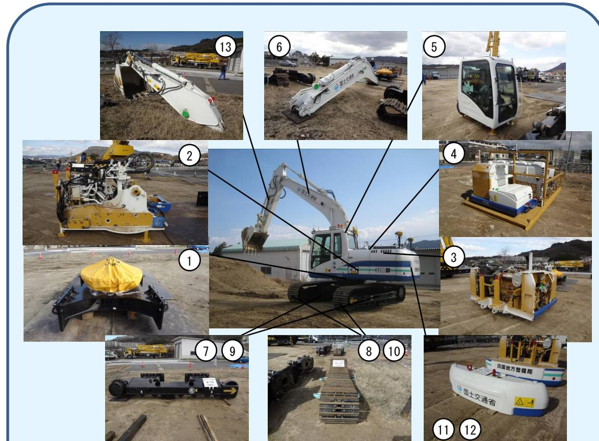
バックホウを13個に分解した時の各パーツ写真
