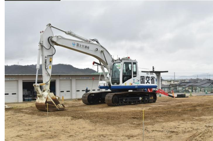
遠隔操縦機能、マシンガイダンス機能を装備しているため、組立後、遠隔操縦操作、マシンガイダンスのバケット等位置精度の確認を行います。
