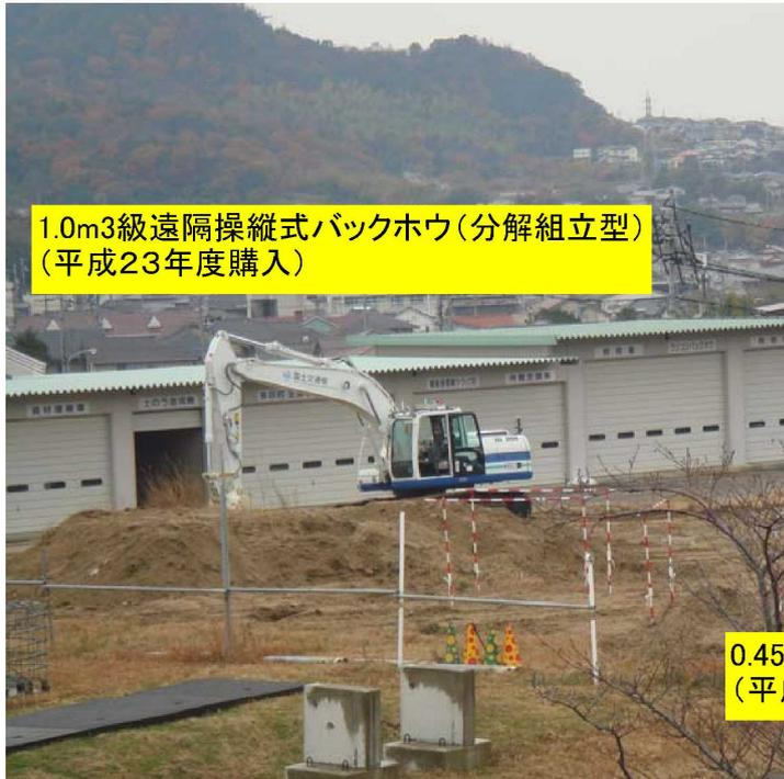
1.0m<sup>3</sup>級遠隔操縦式バックホウ(分解組立型)
