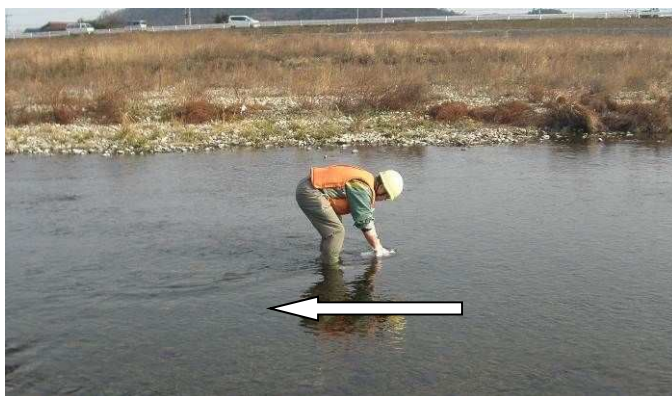
図-3.2 試料容器による直接採水
