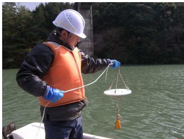
図-2.5 透明度の測定
