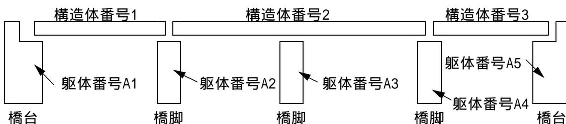
図解-2.1 上部構造の構造体番号と下部構造の躯体番号の概念図
