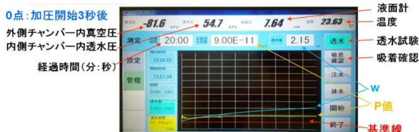
WAPP 法による加圧透水試験（ w と P 値の変化を、時系列表示）
