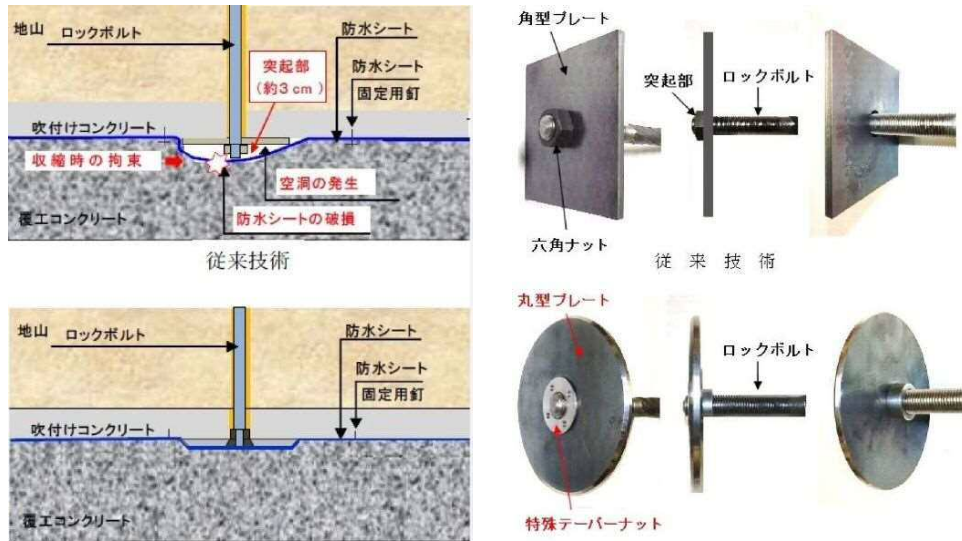
図-15 突出レスロックボルト 33)
