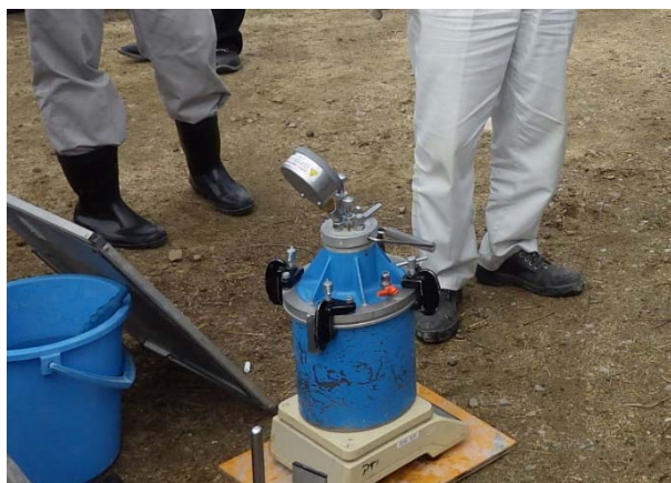
写真 6.10 エアメータ法（土研法）による単位水量測定状況
