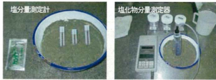
写真 6.7 塩化物含有量測定機器の例
