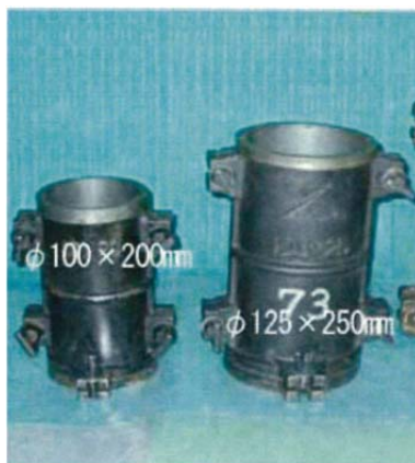
写真 6.7 供試体型枠の種類
