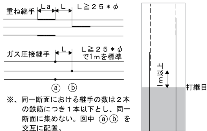
図 3.3 鉄筋の継手位置
