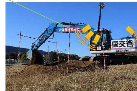
バックホウ装着のカメラ映像
