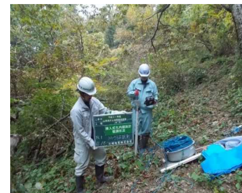
地すべり観測(孔内傾斜計観測状況)
