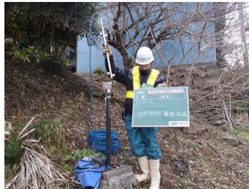
地すべり観測(孔内傾斜計観測状況)
