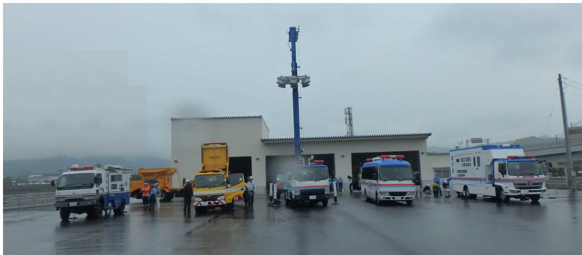
左から 衛星通信車、標識車、照明車、待機支援車、対策本部車
