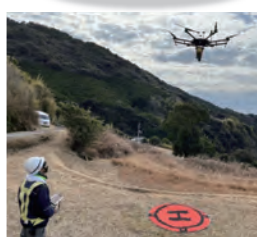
ドローンによるレーザー測量状況
