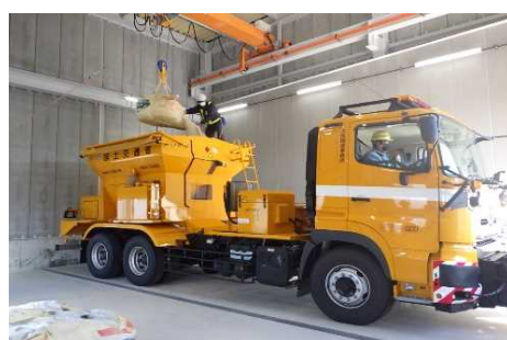
凍結防止剤の積み込み訓練
