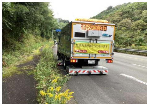
レーダ調査状況
