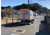
(空洞探査車による調査)
