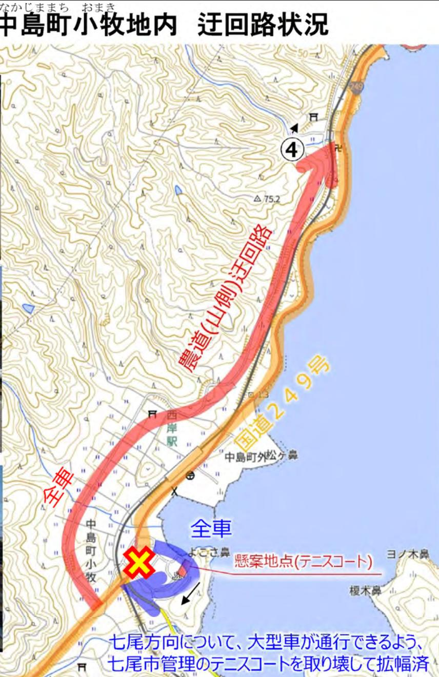
七尾方向について、大型車が通行できるよう、七尾市管理のテニスコートを取り壊して拡幅済
