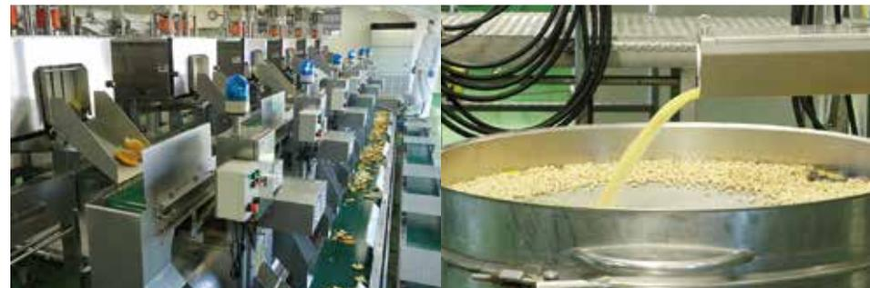
ゆずは洗浄された後、必要に応じて冷蔵（冷凍）保管され、プラントにて皮がむかれ、搾汁され、果汁、皮、それぞれ出荷されてゆく
