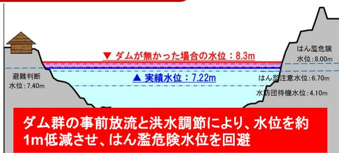
ダム群の事前放流と洪水調節により、水位を約1m低減させ、はん濫危険水位を回避
