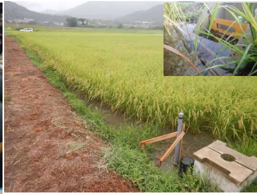
徳島大学との連携により田んぼダムの 効果検証を行うため水位計を設置
