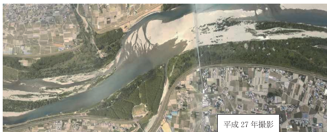
図一6.2.15 西原箇所（左岸距離標 36.4k 付近）における経年的河道変化
