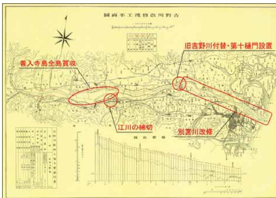
図 - 2.1.3 第一期改修工事竣工平面図(昭和2年)
