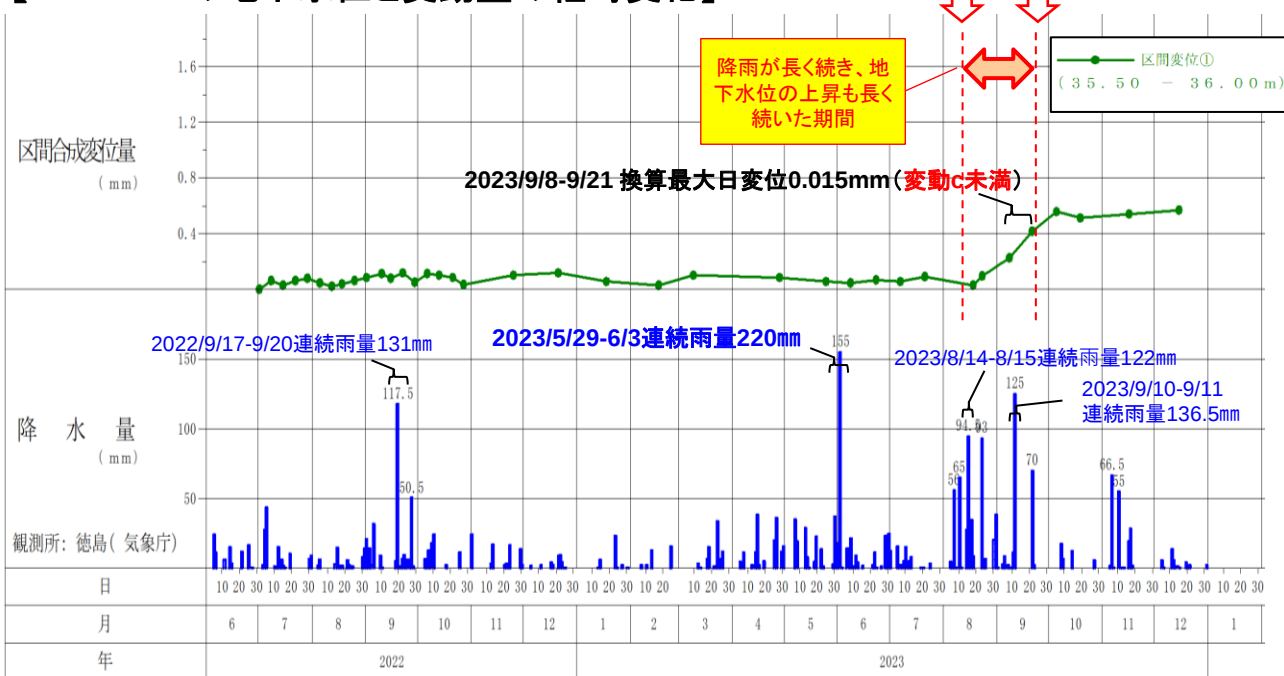
【地盤伸縮計による地盤伸縮の程度とその特徴】
