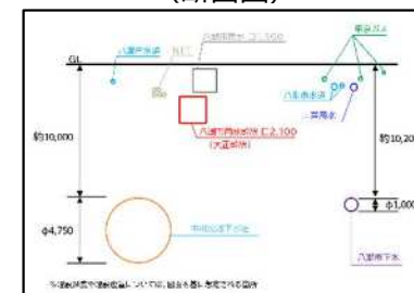
八潮の道路陥没箇所の地下埋設物の状況 (断面図)
