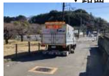
(空洞探査車による調査)
