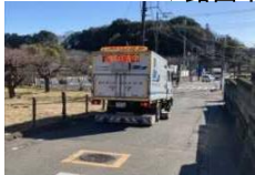
(空洞探査車による調査)
