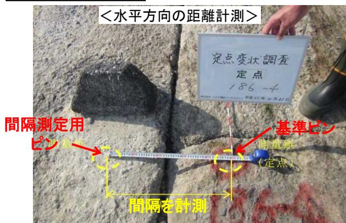
現地に設置している基準ピンと間隔測定用ピンの間隔をメジャーにより簡易計測することで、経年的な変位量を定量的に把握しています。
