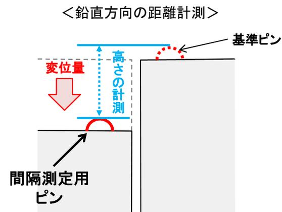
現地に設置している基準ピンと間隔測定用ピンの鉛直方向の間隔をメジャーにより簡易計測することで、経年的な変位量を定量的に把握しています。
