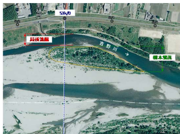
【樹木繁茂による局所洗掘の状況(吉野川 53k/0 付近)】
