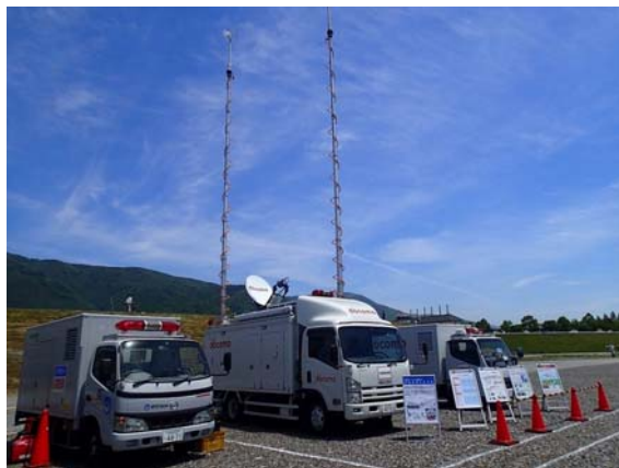
NTT ドコモによる携帯電話回線復旧訓練
