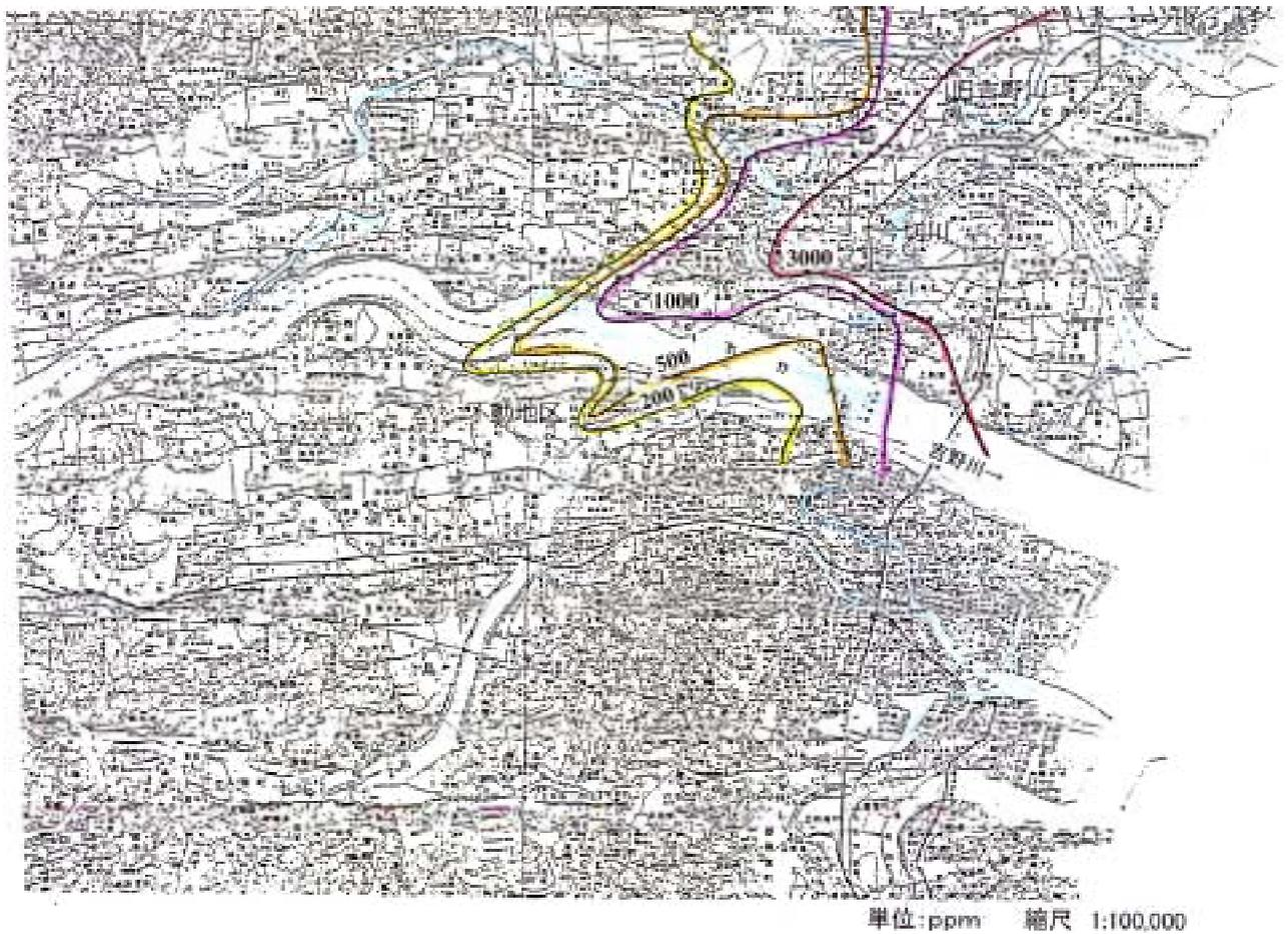
図-6.2.15 吉野川下流域深層地下水の塩分濃度 - 昭和62年 -
